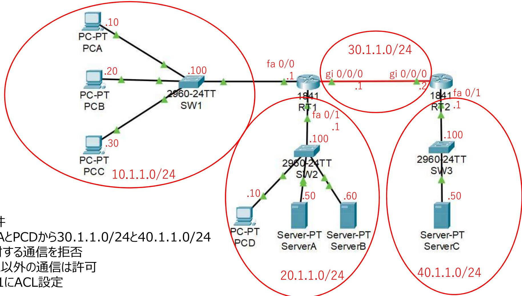
標準ACLを作成しRT1 gi0/0/0 のアウトバウンドにACLを適用
